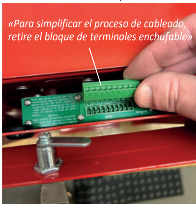
Fig 5: Extracción del bloque de terminales enchufable
